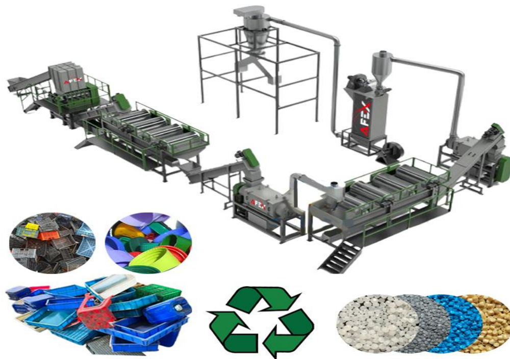
1-Rasm. Qattiq polietilen va polipropilen plastiklarni tozalash va qayta ishlash liniyasi
